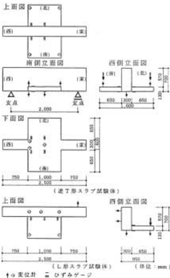
図-1.7 試験体の形状寸法
